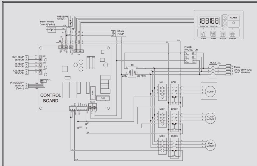
Электрическая схема ICEN (модели WPC-23000 Трехфазная версия)
